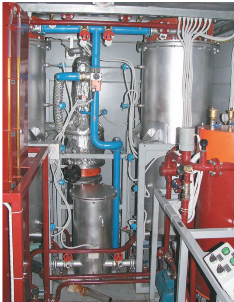
С помощью этой установки регенерацию трансформаторного масла можно не только ускорить, но и значительно удешевить
