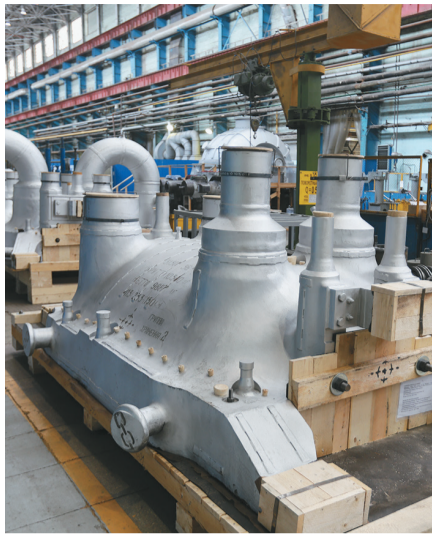
Нижняя половина цилиндра высокого давления Тп-115 для Минской ТЭЦ-3
