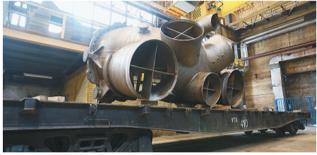
Нижняя половина выхлопной части цилиндра среднего давления турбины Тп-115 для Минской ТЭЦ-3
