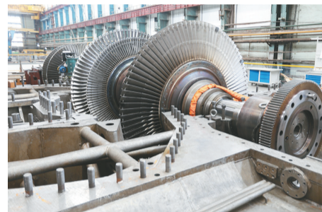
На сборочном стенде узлы турбины Тп-115/130-12,8 готовятся к отправке в Минск
