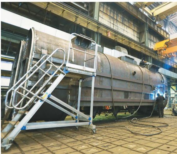
В цехе металлоконструкций УТЗ полным ходом идет работа над изготовлением конденсатора паровой турбины. Сварные металлоконструкции могут достигать массы до 130 т
