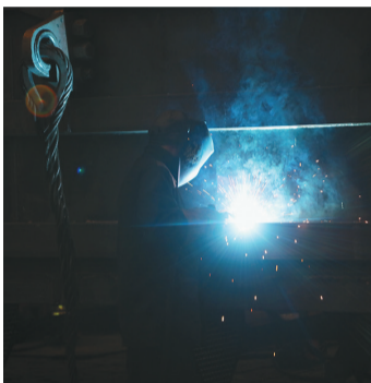
В цехе металлоконструкций УТЗ полным ходом идет работа над изготовлением конденсатора паровой турбины. Сварные металлоконструкции могут достигать массы до 130 т
