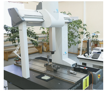
Контрольно-измерительная машина проверяет точность изготовления лопаток турбин
