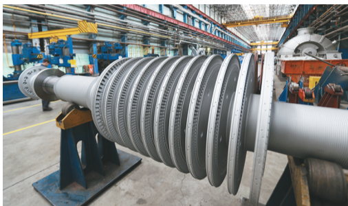
Ротор высокого давления Тп-115 для Минской ТЭЦ-3
