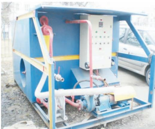
Установка для переработки нефтесодержащих отходов
