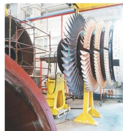
Использование специальных роликовых подставок для замены рабочих лопаток газовой турбины
