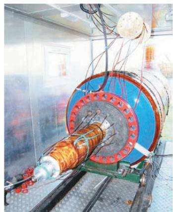
Размещение ВМГ в контейнере генератора токов молнии
