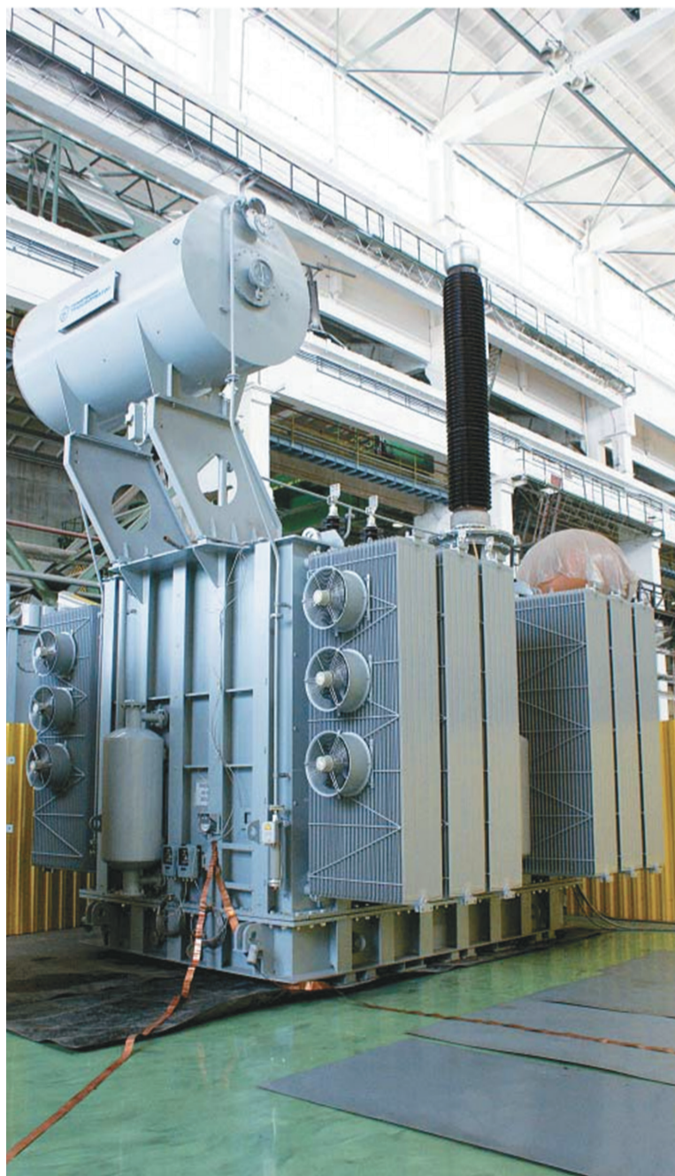
Опытный образец УШРТ-180000/500 УХЛ1 — управляемого тиристорными вентилями шунтирующего реактора
