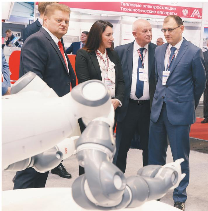
Компания ABB представила на выставке свою разработку YuMi — первого полностью взаимодействующего с человеком двурукого робота, оснащенного гибким программным обеспечением и функциями, которые в совокупности позволяют программировать робота с помощью обучения, а не путем написания программного кода.
