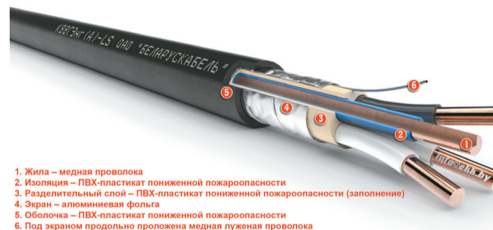
Рисунок 1 — Конструкция КВВГЭнг(А)-LS
