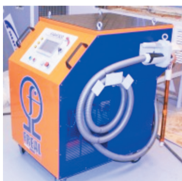
Рис. 3. Установка индукционного нагрева
