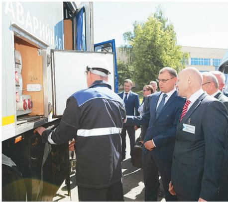
В комплектацию бригадного автомобиля аварийно-восстановительной службы входят дизельная электростанция, сварочный автомат ручной сварки, мотопомпа и погружной насос, прожектор, газоанализатор и другое оборудование
