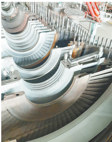
Новые детали проточной части ЦНД
