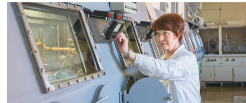
Цепочка боксов, в которой находятся вакуумная установка для изготовления закрытых источников бета-излучения на основе радионуклида трития (Никита Барей, 2016)
