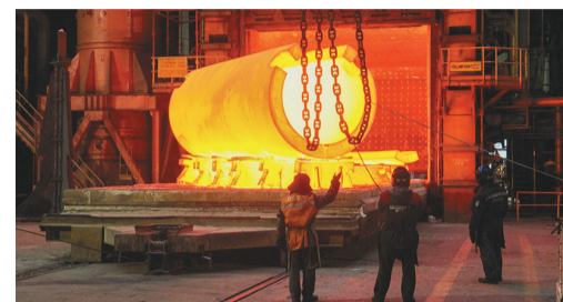
Штамповка днища реактора для турецкой АЭС «Аккую» на заводе «Атомаш» (Евгений Лядов, 2018)
