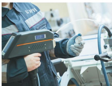
лением химического состава сталей и сплавов, МЛКМиС оснащена современным оптико-эмиссионным портативным спектрометром PMI-MASTER Smart производства компании Oxford Instruments Analytical GmbH (Германия).
