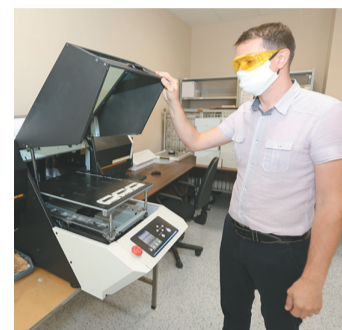
Специализированный принтер с ультрафиолетовыми чернилами заготовки для лицевых панелей счетчиков делает надписи на изделиях максимально устойчивыми к воздействию окружающей среды
