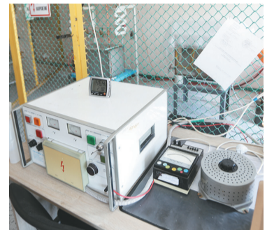
Оборудование, которое специалисты филиала используют для проверки счетчиков
