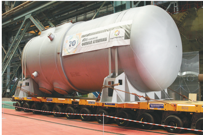
Корпус реактора первого энергоблока стартует из Волгодонска в Островец, 2015 г.
