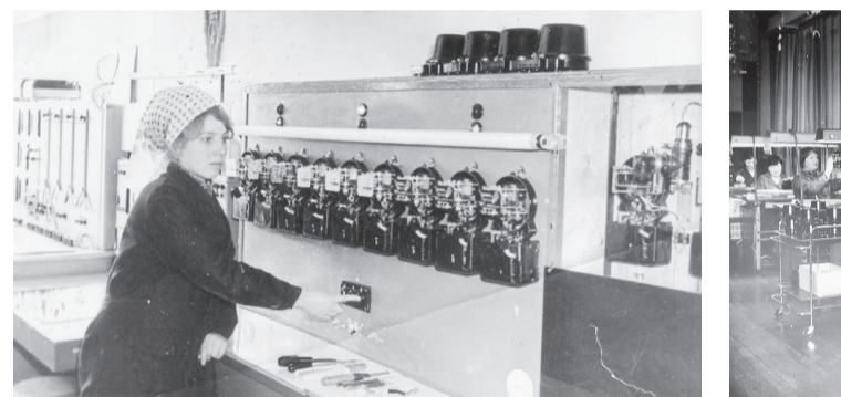
Регулировка электросчетчиков с использованием стробоскопического метода
