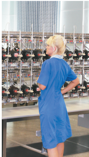
Установка для поверки приборов учета УП 3000 Гран-система-С
