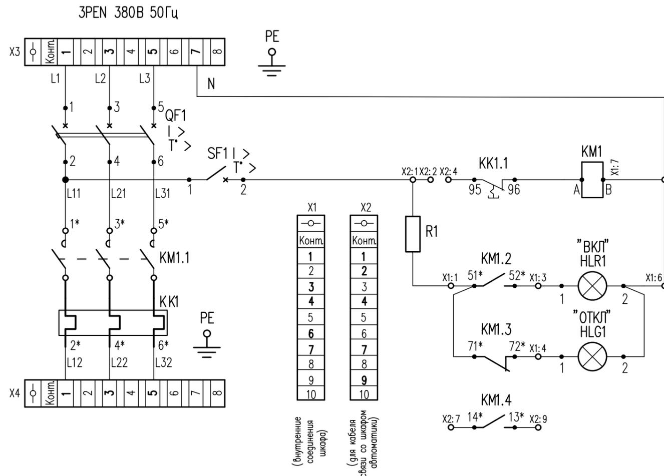
Комплектное низковольтное устройство управления аналог "Шкаф (ящик) управления РУСМ 51\*\*-3774 У5":
